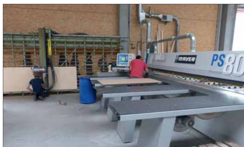
Plattenaufteil-Bereich: Die neue liegende Säge (rechts) steigert die Produktivität, zudem müssen sich die Mitarbeiter weniger mit den großen Platten plagen
