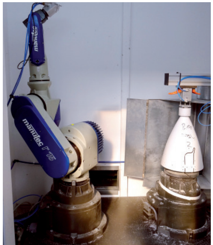
CNC-gesteuerter Roboter in der Fertigungsvorstufe der stromlinienförmigen Propellerverkleidung (sogenannte »Spinner«).
