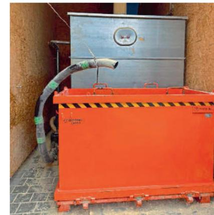
Der Zyklon NZ3 wurde um eine staubdichte Brikettierpresse der Baureihe TH800 mit Aufsatzsilo ergänzt.
